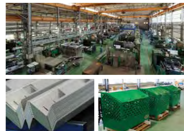
自治体に納品している同社のゴミステーション。アルミ製で軽くて劣化しにくい
