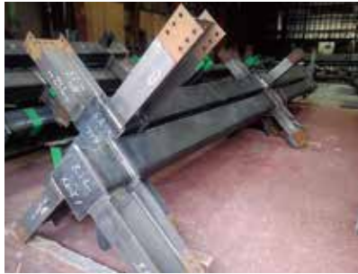
▲加工中の鉄骨の柱
