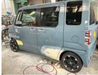
▲钣金作業（外面整形）
