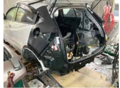
▲钣金作業（フレーム交換）
