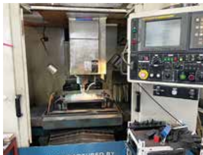
▲NC加工機：高精度輪郭制御による金型製作
