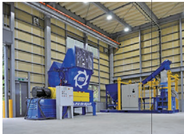
木材、紙、プラスチックを均等に処理する一軸破砕機。
