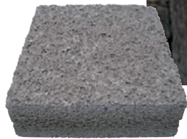
ミクロン単位の微細な気孔が取り巻き、二元的な構造が特長の発泡セラミックス「ハイセラ」。
