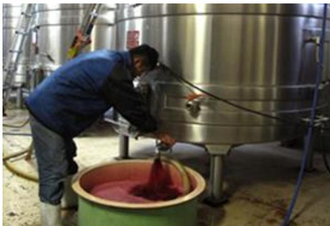
容器の下部より、自然と流れ出た液を抜き出すことを液抜き（フリーラン）と呼びます。
