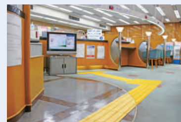
点字ブロック
