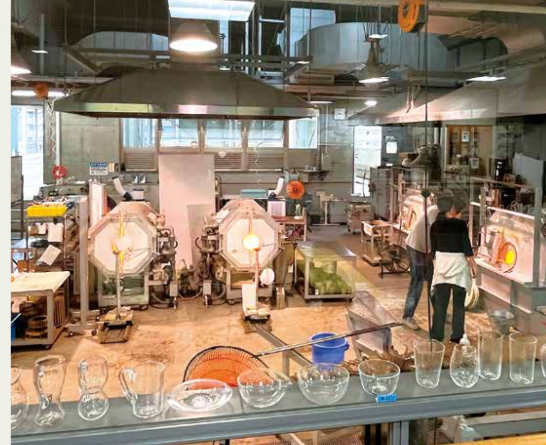
1200度の窯でガラス工芸品を制作する吹きガラス工房教室
