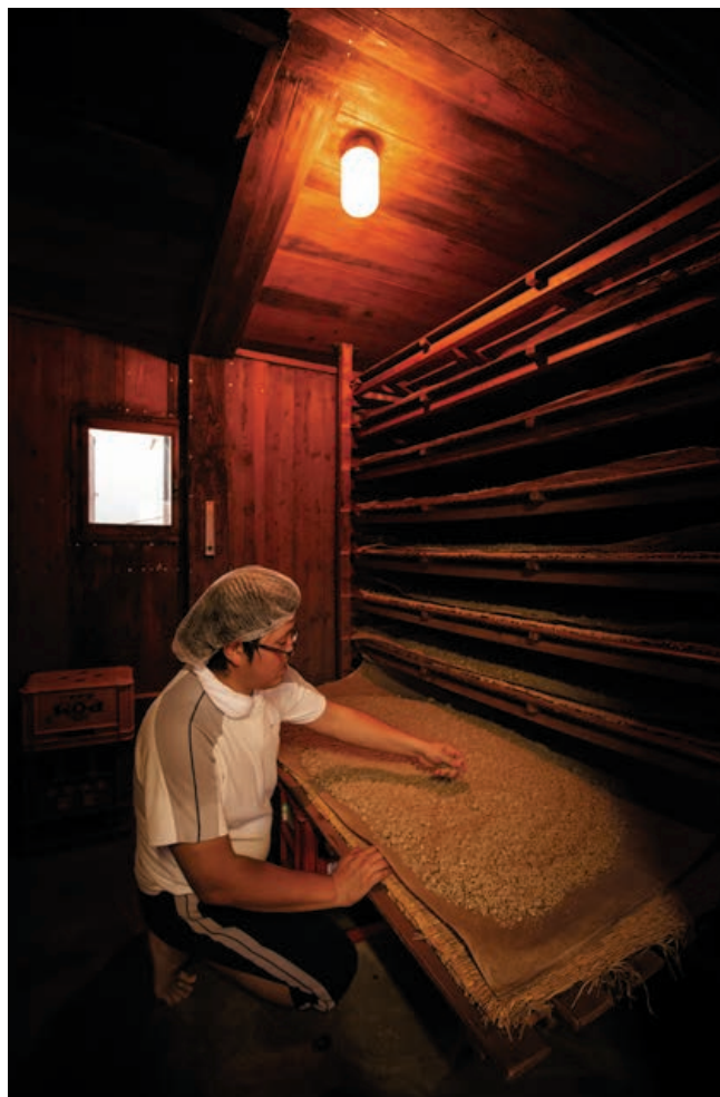
蒸したはだか麦を室（むろ）の中で麦麴にしている作業
