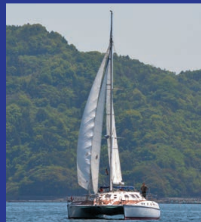
双胴船は、2つの船体を繋いだ構造が特徴で、高い安定性、広い居住スペース、速い航行性能を持つクルージングやレース用ボート
