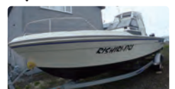
遊漁船「RISHIRI-1721」 ヤマハ発動機 UF-23HT 全長6.27m 幅2.35m エンジン：トーハツ MD50B×2機
