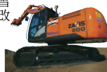
宗谷管内で初めて導入した3Dマシンコントロールシステム搭載のICT油圧ショベル。
