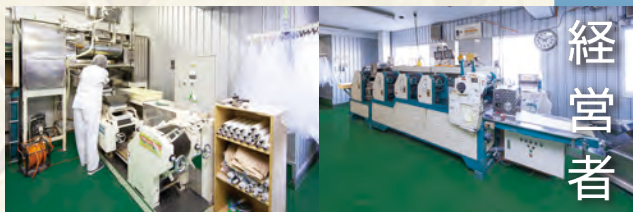
小林食品の工場内部。通常、製麺作業は午前中で終了し、午後から袋詰め、ラベル貼り、箱詰めなど梱包が行われる。写真左：商品毎に異なる粉を投入し、加水し捏ねる機械。右：自動製麺機。それぞれの用途に合わせ麺帯巻、熟成、圧延、麺線（切出し）する機械。
